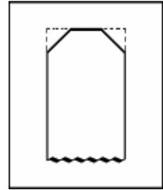
Рис.5 Схема реза углов манжеты.
