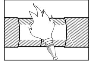
Рис. 3 Нагрев изолируемой поверхности.
