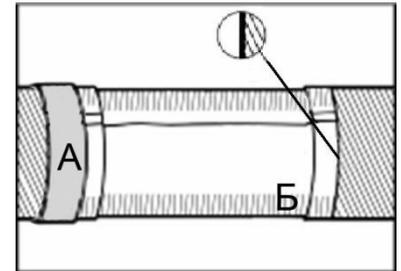
Рис.10 Вид качественной изоляции стыка.
