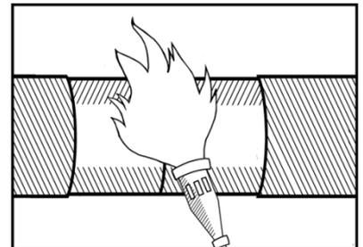
Рис. 1 Сушка изолируемой поверхности.
